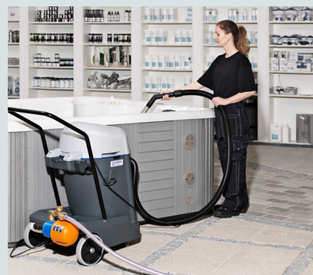
Une pompe de refoulement est disponible et constitue la solution idéale pour déplacer des volumes importants de liquides
