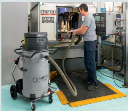
Aspiration de copeaux et d'huile d'une machine-outil
