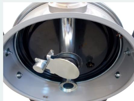
Défecteur avec clapet métallique pour arrêter l'aspiration pendant la phase de déchargement
