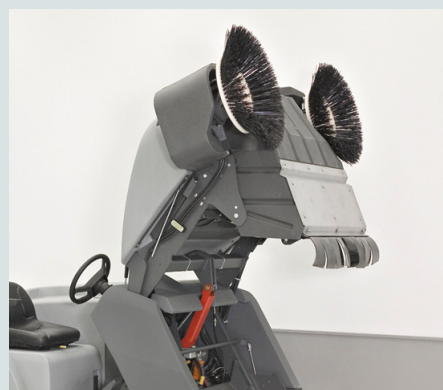
La SW8000 offre une exceptionnelle hauteur de vidage, jusqu'à 1,52m. L'opérateur peut facilement contrôler le vidage car il bénéficie d'une excellente visibilité
