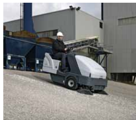
Capacité de travail en pente - jusqu'à 25 %.
